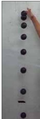
Figura 7.7 – Exemplo de fotografia estroboscópica da queda de uma bola, obtida por meio do software
